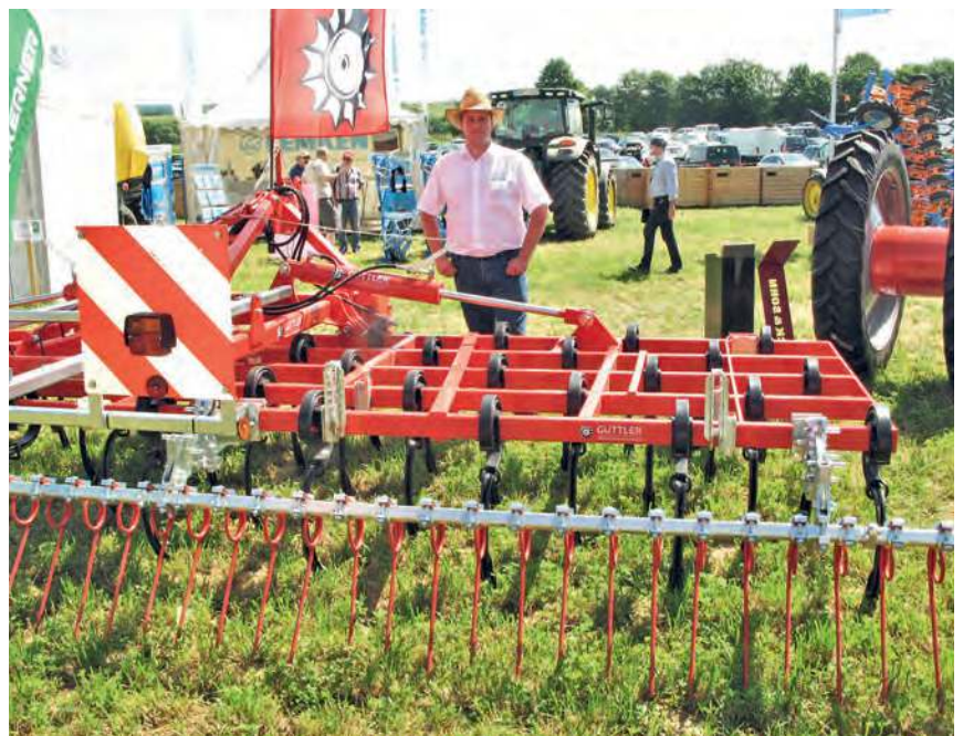
Gütter führte die fünfbalkige Großfederzahnegge SuperMaxx vor. Das Ganzjahresgerät könne zur Saatbettbereitung ebenso eingesetzt werden wie zur flachen Stoppelbearbeitung, zum Einarbeiten von Gülle, zur Durchlüftung nasser und schwerer Böden oder auch zur effektiven Bekämpfung von Unkräutern.
