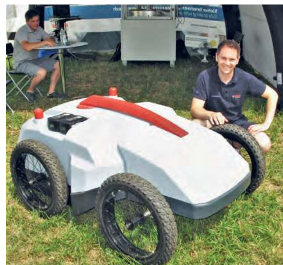
Markus Hoferlin, Deepfield Robotics, zeigte einen autonomen Roboter für die mechanische, aber auch chemische Unkrautbekämpfung.
