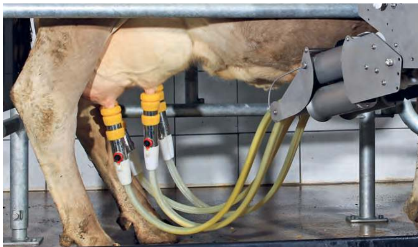
Mit dem Multilactor von Siliconform soll das Saugen des Kalbes imitiert werden. Bei dem speziell für Biobetriebe entwickelten Melkzeug Bio-Milker wurde die Zitzengummibewegung der Zungenfrequenz von Kälbern angepasst.
