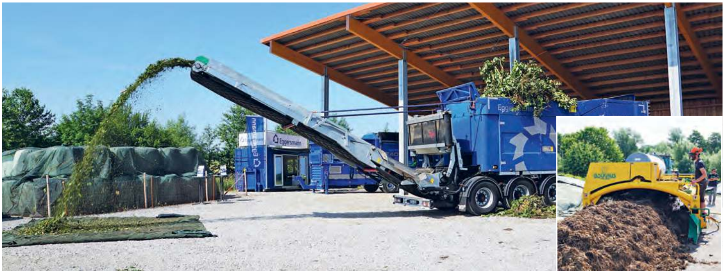
In der Sonderschau Kompost wurde den Zuschauern gezeigt, in welcher kurzer Zeit der Zerkleinerer Teuton von Eggersmann (großes Bild) groben Grünschnitt in homogenes Material verwandeln kann. Ebenso viel Aufmerksamkeit erhielt der Umsetzer von Backhus (kleines Bild): Die Umsetzleistung liegt bei 700 m 3 pro Stunde.
